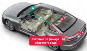
Рекомендуемое место монтажа второй камеры
